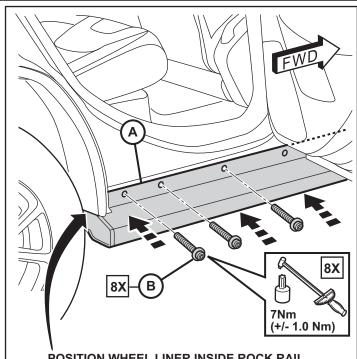
POSITION WHEEL LINER INSIDE ROCK RAIL Position de doublure rail intérieur
